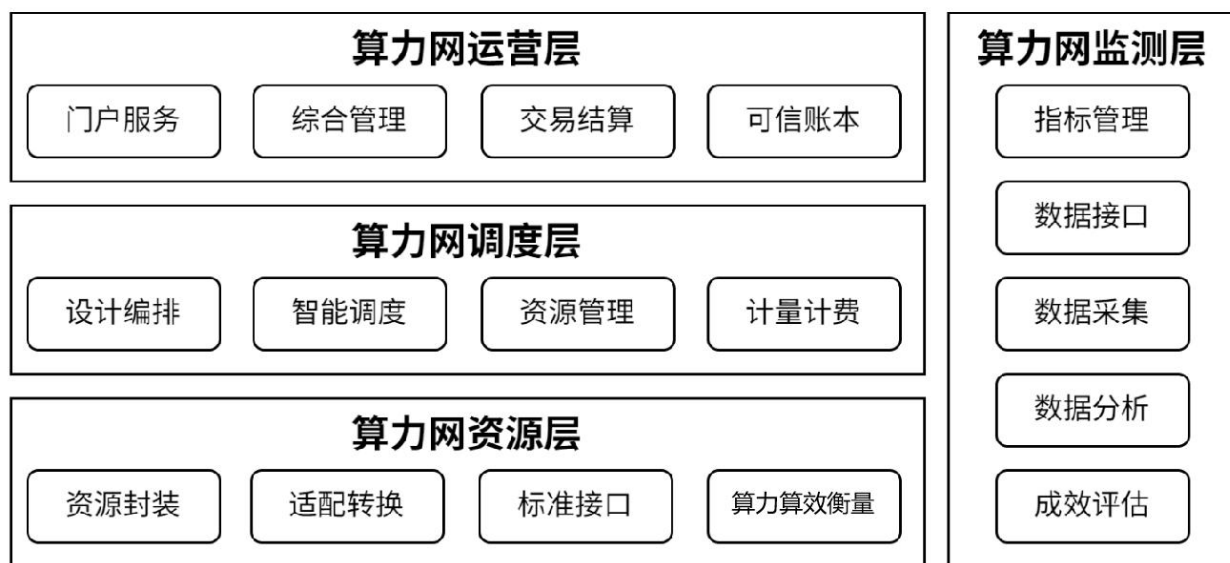
图1 全国一体化算力网监测调度平台总体框架示意图
